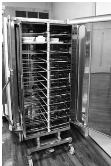
カート内でチルド保存、配膳前に自動再加熱ができる再加熱カートシステム
